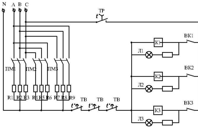
**Рис. 2 Схема электрическая принципиальная электроводонагревателей ЭВПМ-36 и ЭВПМ-48, где**
